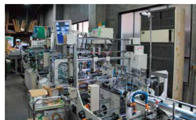
全長約10mの自動製箱機
