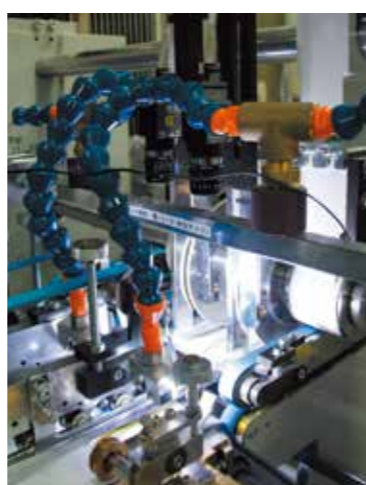
品質管理の要となるカメラ各所に設置されている
