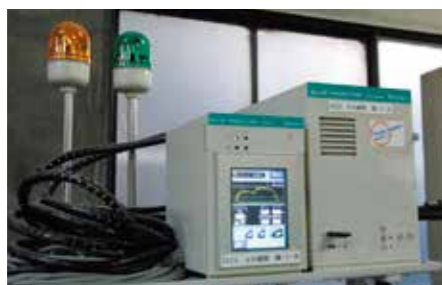
折りや貼り付けもセンサーで品質管理する
